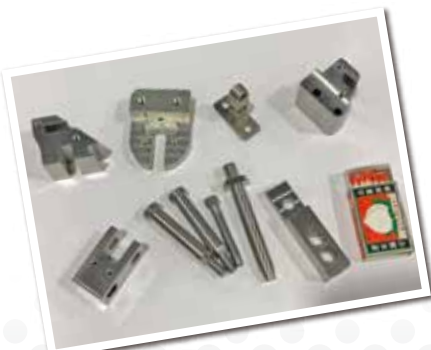
マッチサイズのネジ、 金属部品を角材からつくります
